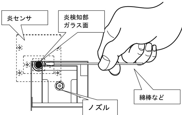
インナケーシングまで取り外した状態でお手入れします。炎センサはノズルの上側にあるスキマの奥にあります。柄の長い綿棒や割り箸の先端にティッシュペーパーなどを巻き付けたものに洗剤を染み込ませて、炎センサの炎検知部を拭いてください。
