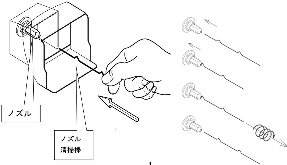
インナケーシングまで取り外した状態でお手入れします。ノズルの位置をご確認ください。専用のノズル清掃棒をノズルの穴に挿入して、クルクルと回転させてください。
